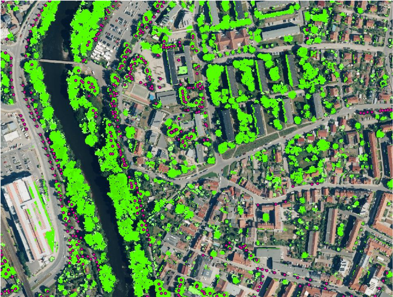
Abbildung 27: Baumkataster und über NDVI und Strukturhöhe abgeleitete Baumstandorte. Punkte: Baumkataster, grüne Flächen sind abgeleitete Baumkronen.
