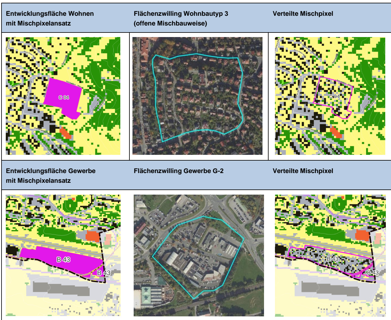
Abbildung 23: Prinzip der Verteilung der Mischpixel anhand eines Flächenzwillings. Eigene Darstellung
